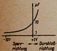
Bild 1. Eine Patentezeichnung aus dem Jahre 1939 zeigt bereits die Abhängigkeit der Sperrschichtkapazität von der Spannung
